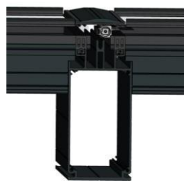
Montant 142mm Moment d'inertie : 281 cm 4
